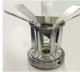
Der MIRIAM-2 Ballonbehälter bei geöffneter „Blüte“. ARCHIMEDES Ballonbehälter und Auswurfmechanismen werden sehr ähnlich aussehen für den größeren ARCHIMEDES Ballon
